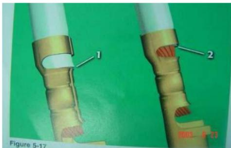
Figura 5.10 Contactor no calificado
